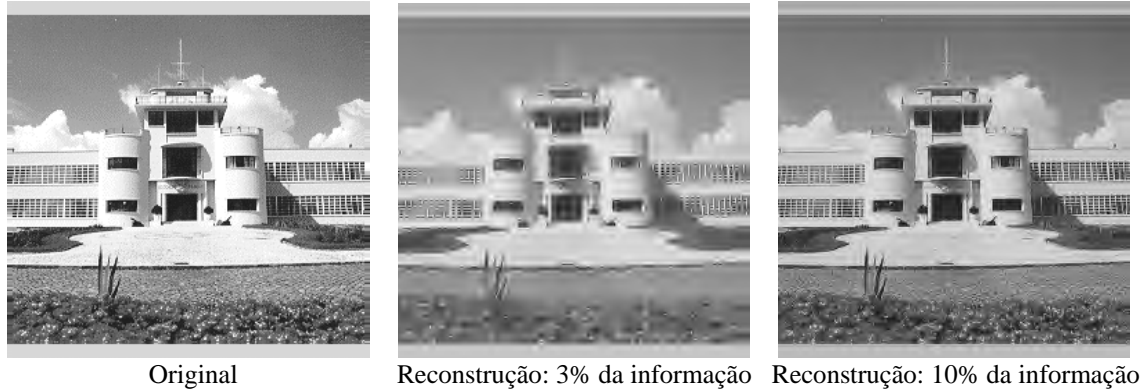
Fig. 11 - Reconstrução por onduletas da Escola Naval. Cortesia do Professor Amaro Rica da Silva
